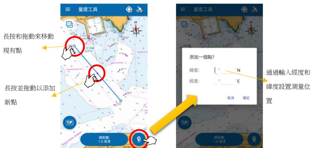
測量線上的最後一段將附加距離和真方位角。所有線段的總距離將顯示在地圖的底部。
